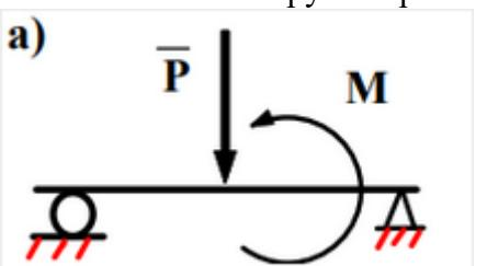
а) сосредоточенная сила, сосредоточенный момент; б) сосредоточенный момент, распределенная нагрузка; в) сосредоточенный момент, осевая сосредоточенная сила; г) распределенный момент, распределенная нагрузка.
