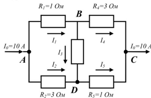
$$\begin{cases} I_1 + I_2 = 10 \\ I_1 - I_3 - I_4 = 0 \\ I_2 + I_3 - I_5 = 0 \\ I_4 + I_5 = 10 \\ I_1 + 3I_4 - 10R_0 = 0 \\ 3I_2 + I_5 - 10R_0 = 0 \\ I_1 + 2I_3 + I_5 - 10R_0 = 0 \\ 3I_2 - 2I_3 + 3I_4 - 10R_0 = 0 \end{cases}$$
