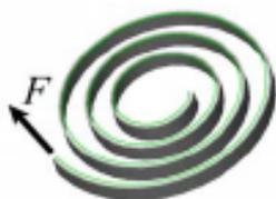
**Задание 20.** Экспериментально установлено, что зависимость угла закручивания  $\varphi$  плоской спиральной пружины от приложенной силы  $F$  можно рассчитать по формуле
