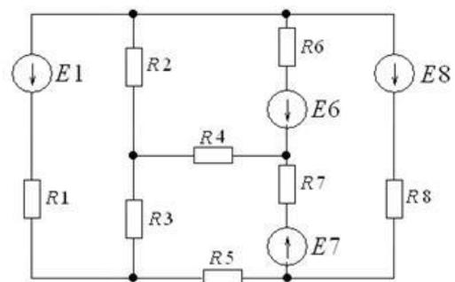
$E_1=25 \text{ В}$ ;  $E_6=0 \text{ В}$ ;  $E_7=0 \text{ В}$ ;  $E_8=15 \text{ В}$ ;  $R_1=1,8 \text{ Ом}$ ;
