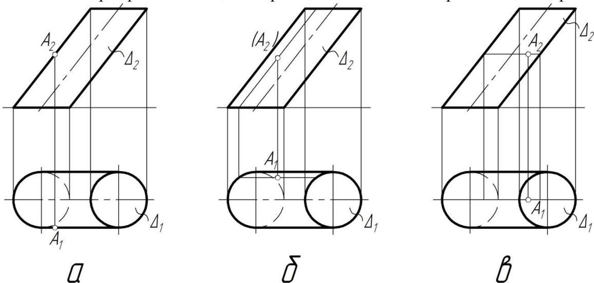
41. На каком эюре правильно найдены проекции точки В на поверхности цилиндра
