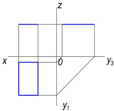
10. Дан чертеж четырехугольной плоскости в трех проекциях, на каком чертеже изображена плоскость перпендикулярная  $\Pi_3$
