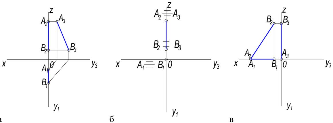
32. Прямая АВ задана тремя проекциями, на каком чертеже прямая АВ параллельна горизонтальной плоскости проекций ( $\Pi_1$ )
