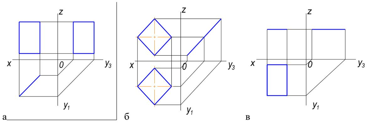
9. Дан чертеж четырехугольной плоскости в трех проекциях, на каком чертеже изображена плоскость параллельная  $\Pi_1$
