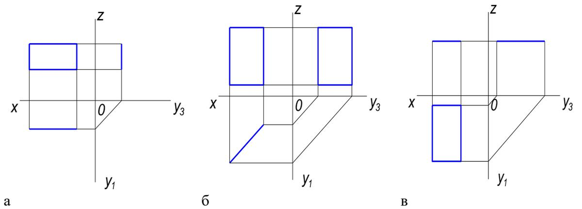
12. Дан чертеж треугольной плоскости в трех проекциях, на каком чертеже изображена плоскость перпендикулярная  $\Pi_1$
