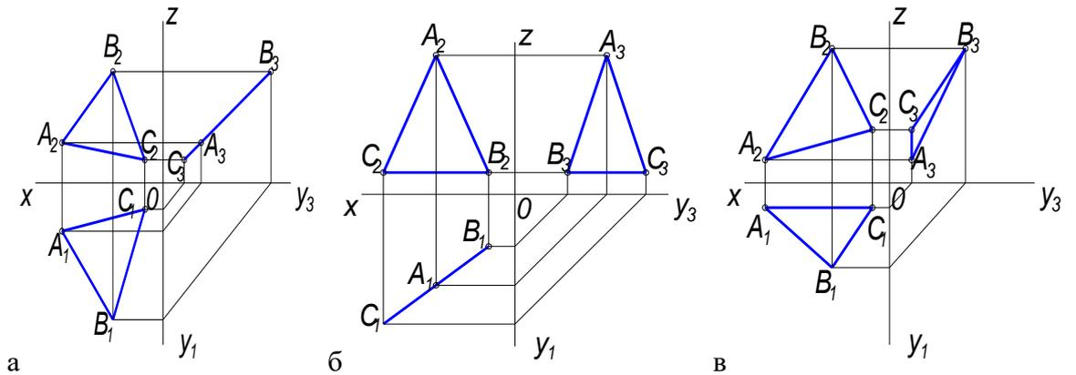
13. Дан чертеж треугольной плоскости в трех проекциях, на каком чертеже изображена плоскость перпендикулярная  $\Pi_2$
