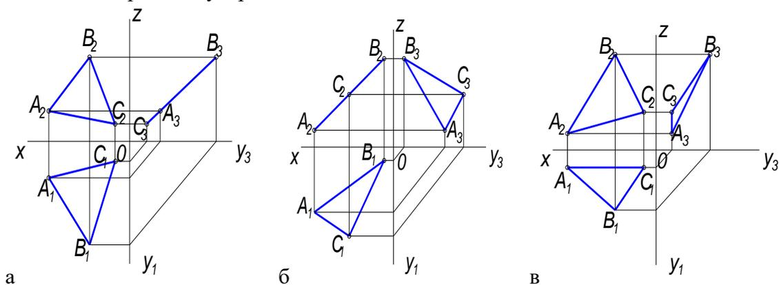
15. Дан чертеж треугольной плоскости в трех проекциях, на каком чертеже изображена плоскость параллельная  $\Pi_3$
