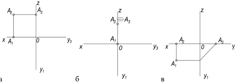
15. На каком чертеже точка А расположена на профильной плоскости проекций ( $\Pi_3$ )
