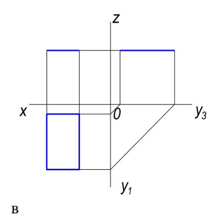
10. Дан чертеж четырехугольной плоскости в трех проекциях, на каком чертеже изображена плоскость перпендикулярная  $\Pi_3$
