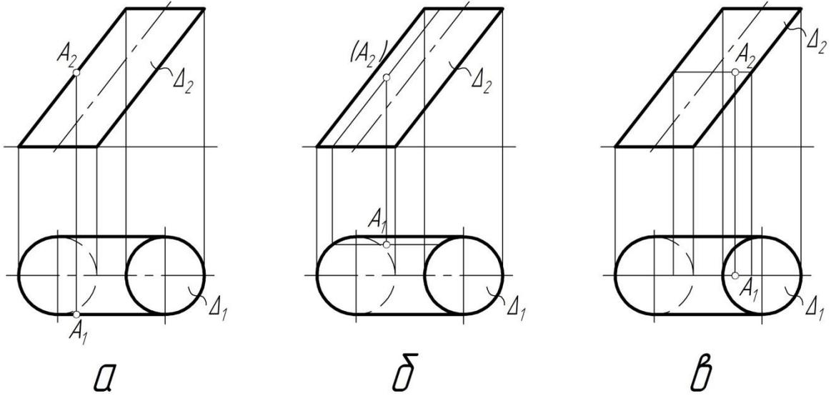
41. На каком ээпуре правильно найдены проекции точки В на поверхности цилиндра?
