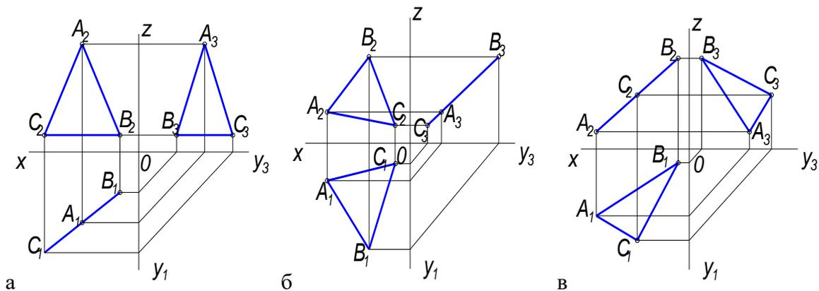
14. Дан чертеж треугольной плоскости в трех проекциях, на каком чертеже изображена плоскость перпендикулярная  $\Pi_3$
