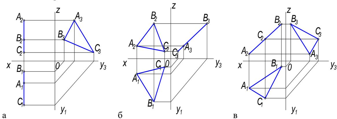
16. Дан чертеж треугольной плоскости в трех проекциях, на каком чертеже изображена плоскость наклонна к плоскостям  $\Pi_1, \Pi_2, \Pi_3$
