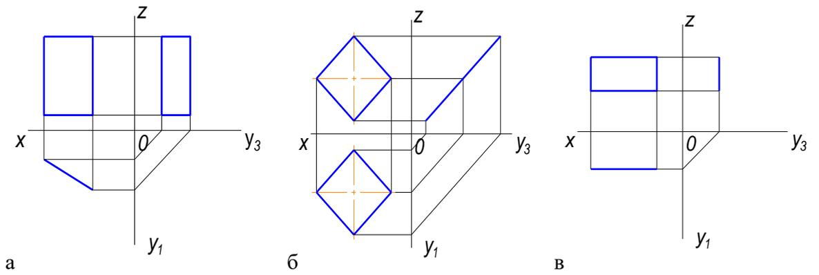
11. Дан чертеж четырехугольной плоскости в трех проекциях, на каком чертеже изображена плоскость параллельная  $\Pi_2$
