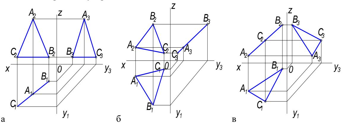
14. Дан чертеж треугольной плоскости в трех проекциях, на каком чертеже изображена плоскость перпендикулярная  $\Pi_3$
