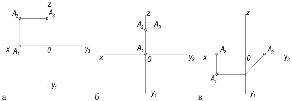
14. На каком чертеже точка А расположена на профильной плоскости проекций ( $\Pi_3$ )
