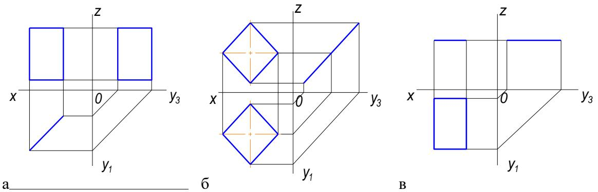
9. Дан чертеж четырехугольной плоскости в трех проекциях, на каком чертеже изображена плоскость параллельная  $\Pi_1$
