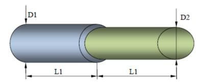
2. Определить потери напора в рукавной системе, при заправке пожарного автомобиля АЦ-40 (130) 63Б, состоящей из пожарного гидранта ПГ-подземный с общим расходом воды  $Q=22~\mathrm{n/c}$ , пожарной колонки ПК-колонка и рукавной линии диаметром D = 77 мм, и длинной  $L=100~\mathrm{m}$ . Высота пожарного автомобиля 2,5 метра.
